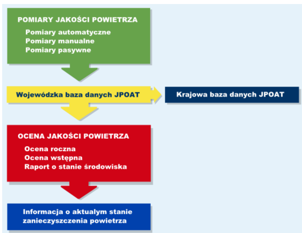
Rysunek 4.1 Schemat funkcjonowaniu monitoringu ochrony powietrza
