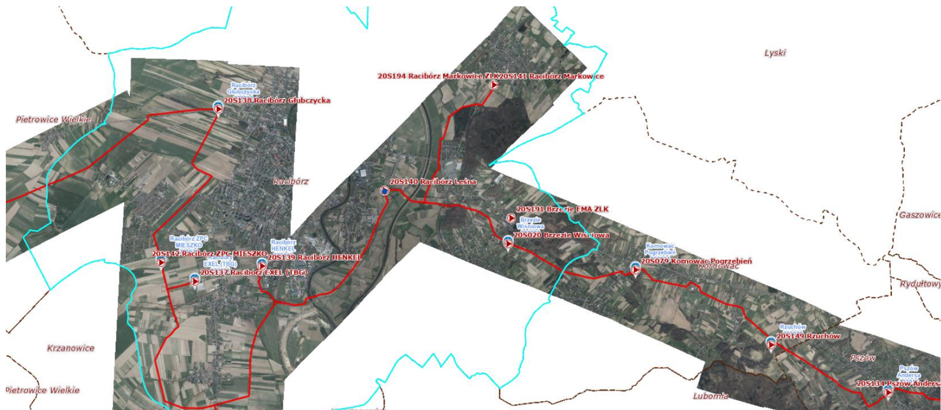
Rysunek 3.2 Przebieg rurociągów wysokiego ciśnienia i lokalizacja stacji redukcyjno-pomiarowych I stopnia na terenie miasta Racibórz
