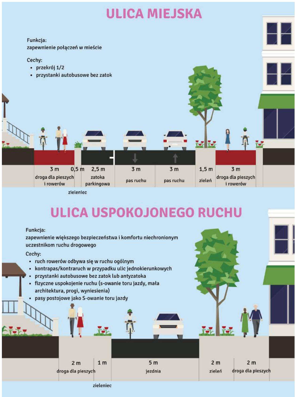
Rysunek 6.15 Proponowany przekrój poprzeczny ulicy – miejska oraz uspokojonego ruchu.
