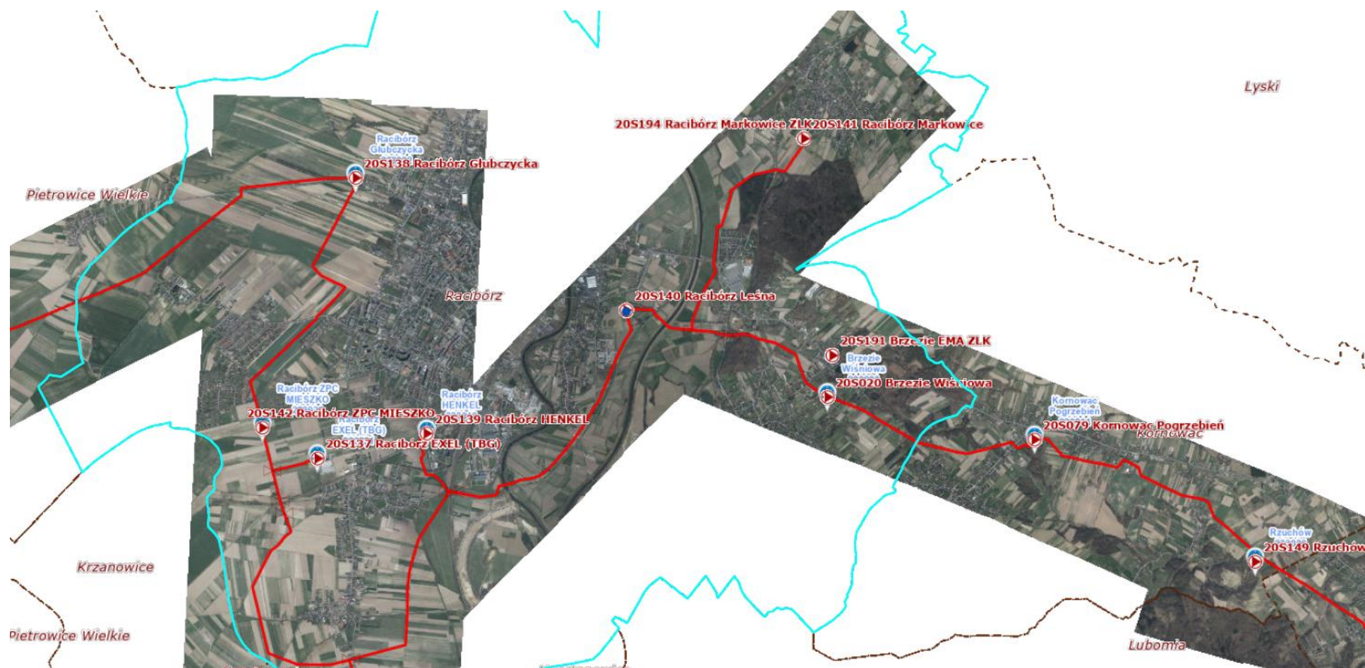
Rysunek 3.2 Przebieg rurociągów wysokiego ciśnienia i lokalizacja stacji redukcyjno-pomiarowych I stopnia na terenie miasta Racibórz
