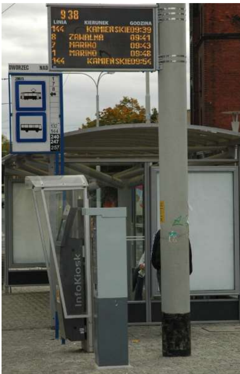
Rysunek 23. Przykładowe wyposażenie nowoczesnego przystanku autobusowego.
