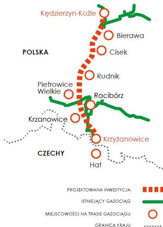
Rysunek 3.3 Przebieg inwestycji związanej z realizacją projektu Interkonektor Polska-Czechy
